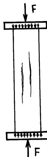
Obr. 1.8 Porušení zkušebního hranolu
